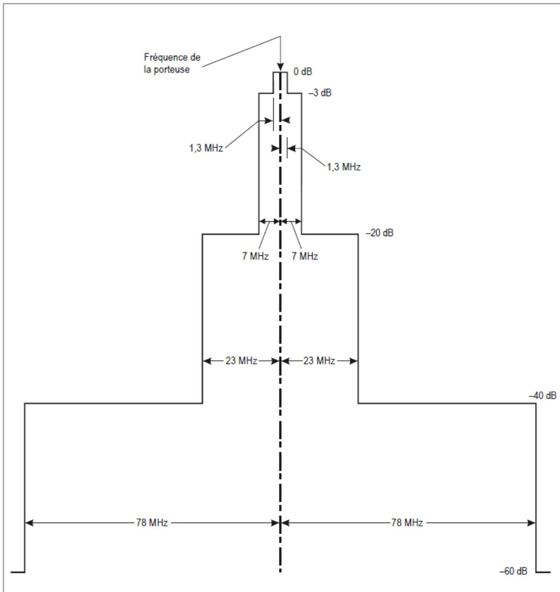
Figure 3-5. Limites du spectre pour le transpondeur
