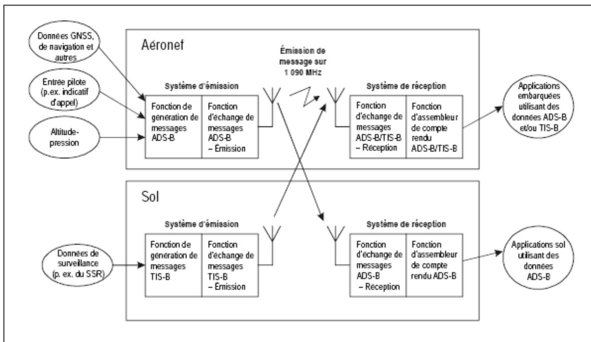
Figure 5-1. Modèle fonctionnel de système ADS-B/TIS-B
