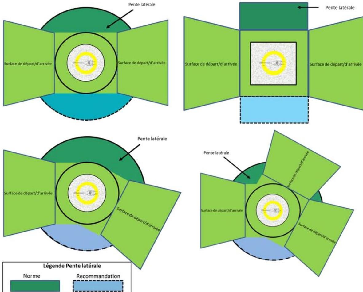
*Note. — Ces diagrammes illustrent plusieurs configurations d'aire de sécurité/pente latérale de la FATO. Pour une disposition arrivée/départ consistant en : deux surfaces qui ne sont pas diamétralement opposées, plus de deux surfaces, ou un secteur dégagé d'obstacles (OFS) étendu attenant directement à la FATO, on peut voir que des dispositions appropriées sont nécessaires pour garantir qu'il n'y ait pas d'obstacle entre la FATO et/ou l'aire de sécurité et les surfaces d'arrivée/départ.*
