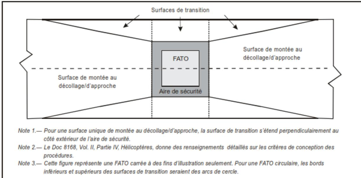
**Figure 4-3. Surfaces de transition dans le cas d'une FATO avec procédure d'approche PinS avec VSS**
