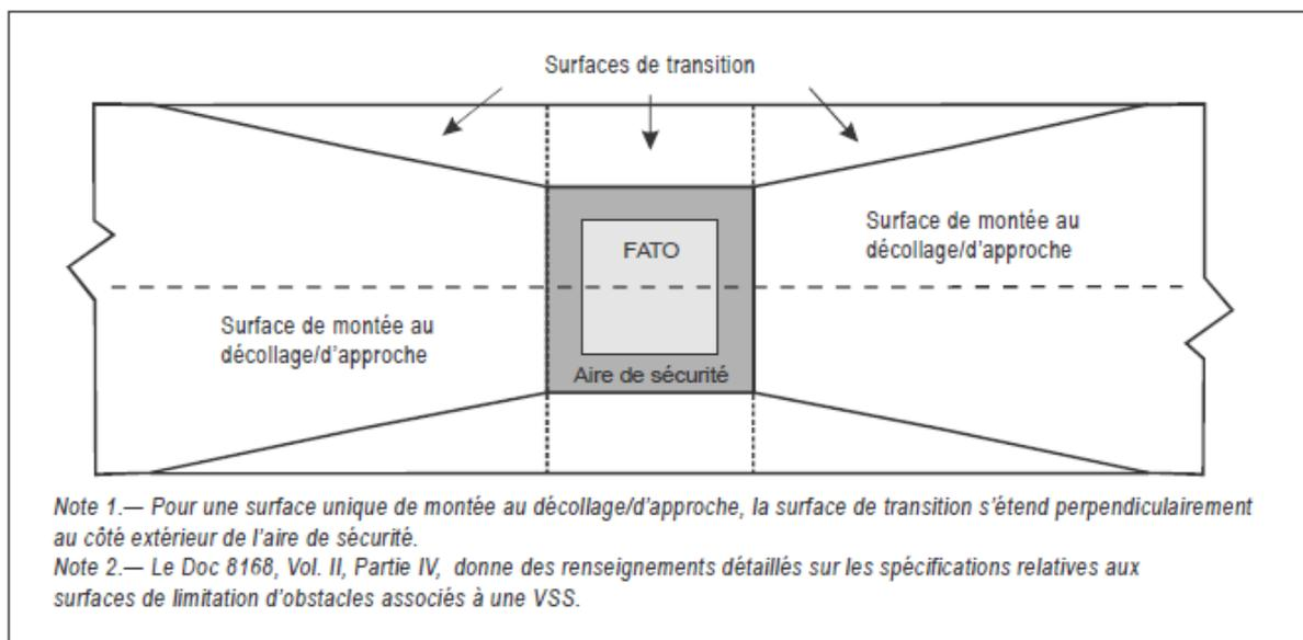
Note 1.— Pour une surface unique de montée au décollage/d'approche, la surface de transition s'étend perpendiculairement au côté extérieur de l'aire de sécurité.
