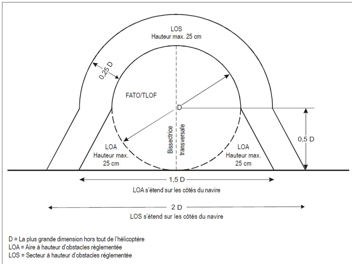
**Figure 4-11. Secteurs et surfaces de limitation d'obstacles — Hélisation non construite spécialement et située sur le côté d'un navire**
