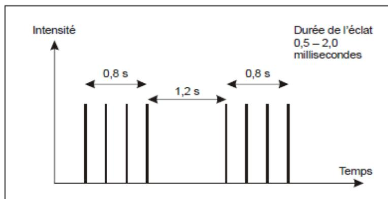
Figure 5-11. Caractéristiques d'éclat du phare d'hélistation
