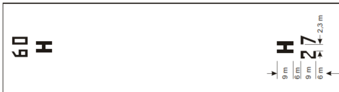
Figure 5-2. Marque d'identification de FATO et marque distinctive d'hélisation pour une FATO de type piste
